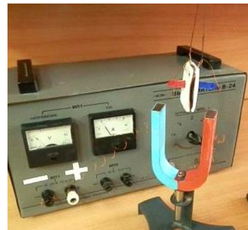
Рис. 9 Ориентация замкнутого контура в поле постоянного магнита
