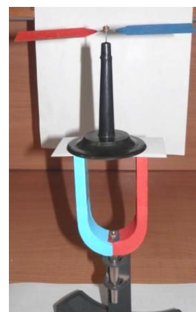
Рис. 8 Ориентация магнитной стрелки в поле постоянного магнита
