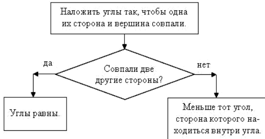
Рис.5. Алгоритм сравнения углов
