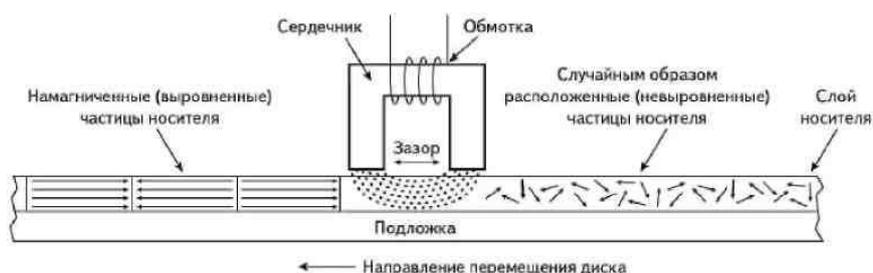
Рис. 1: Головка чтения/записи
